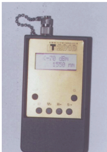
Рис.10. Измеритель оптической мощности ПТ2010
