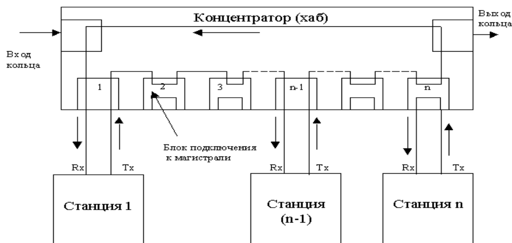
Рис. Топология Token Ring.
