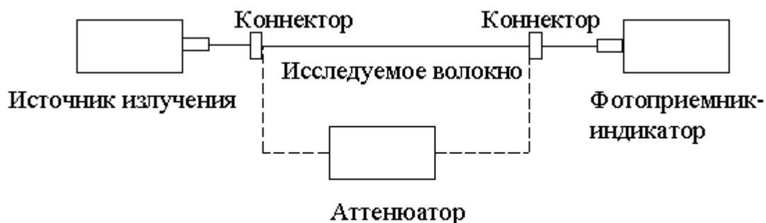
Рис.2.5.4. Схема измерения потерь с помощью аттенюатора.
